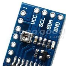
Na LCD je zespodu převodník, který převádí I2C komunikaci na display. Na tomto převodníku je malý trimr, kterým je možno nastavovat kontrast displeje. Taktéž je tam 4pinový konektor, kterým se propojuje modul displeje s deskou procesoru. Všechny piny jsou jasně popsány, takže by neměl nastat žádný problém. Obrázek je pouze ilustrativní a může se lišit podle použitého typu převodníku.
