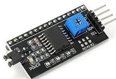
Tento LCD displej musí být ještě vybaven převodníkem komunikace, neboť stopky s ním komunikují po sběrnici I2C. Těchto převodníků existuje celá řada, ale ne každý může být použit. Respektive záleží na tom, který převodník je definován ve firmwaru. V současné době je nastaven převodník, jež je vyobrazen na obrázku.
